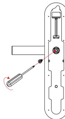
После регулировки направления рукоятки вставьте ее в шестигранный винт рукоятки, чтобы завершить поворот. Закрепите винт.
