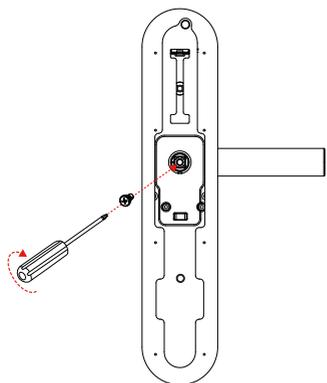
После регулировки направления рукоятки вставьте ее в шестигранный винт рукоятки, чтобы завершить поворот. Закрепите винт.
