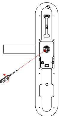
Поверните ручку на передней панели. Ослабьте внутренний шестигранный винт рукоятки против часовой стрелки.
