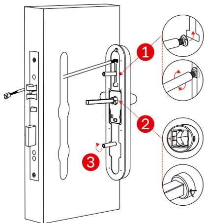
1. Установите и отрегулируйте положение верхнего скользящего винта, в зависимости от расположения отверстия сверления или старого дверного отверстия.
