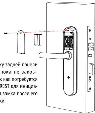
\*Крышку задней панели лучше пока не закрывать, так как потребуется кнопка REST для инициализации замка после его установки.
