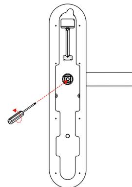
Поверните ручку на задней панели. Ослабьте внутренний шестигранный винт рукоятки против часовой стрелки.
